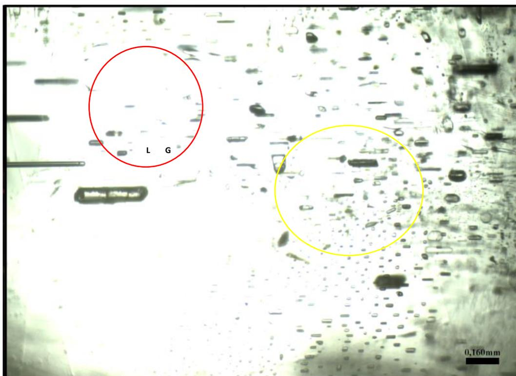
**Figura 7.** Inclusões em água-marinha evidenciando os Grupos I, em amarelo, e II, em vermelho, onde a fase líquida (L) e gasosa (G), podem ser identificadas.
