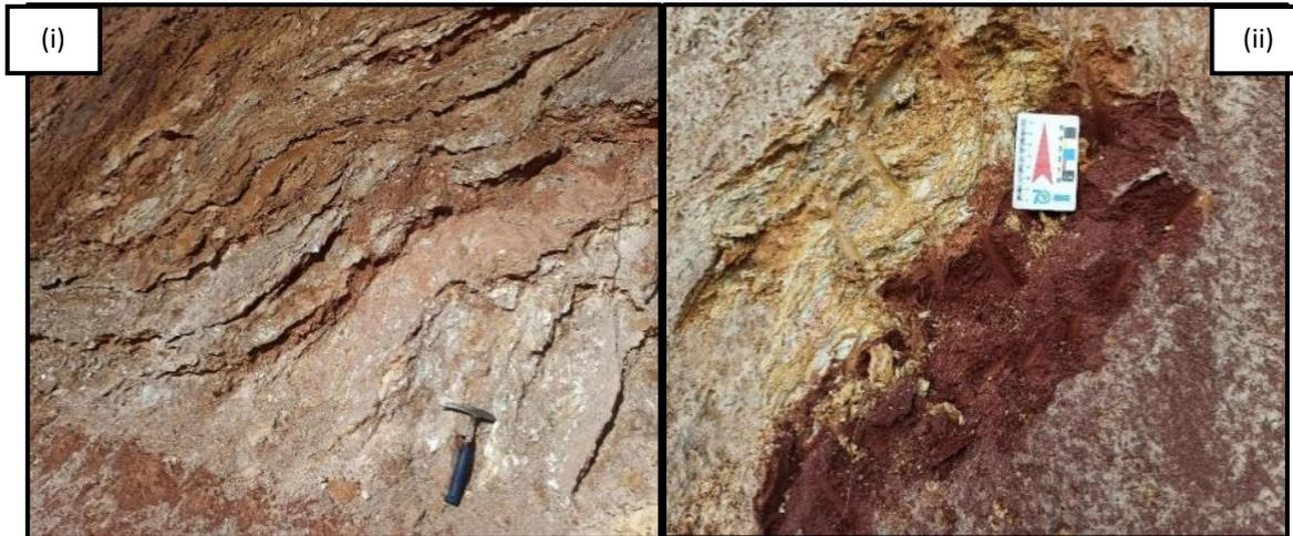
**Figura 5.** (i) Granitoide granoblástico Jacém muito alterado com porfiroblastos de feldspato presentes na rocha. (ii) Diferença das camadas de rocha, a parte grená pode representar um dique de anfíbolito.
