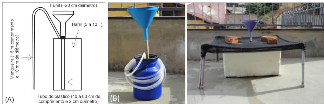
Figura 4. (A) Esquema de recipiente para coleta de água pluvial conforme sugerido pela IAEA (2002) e (B) recipiente utilizado nessa pesquisa, montado dentro de um isopor e sob tela de sombrite para proteção da insolação.
