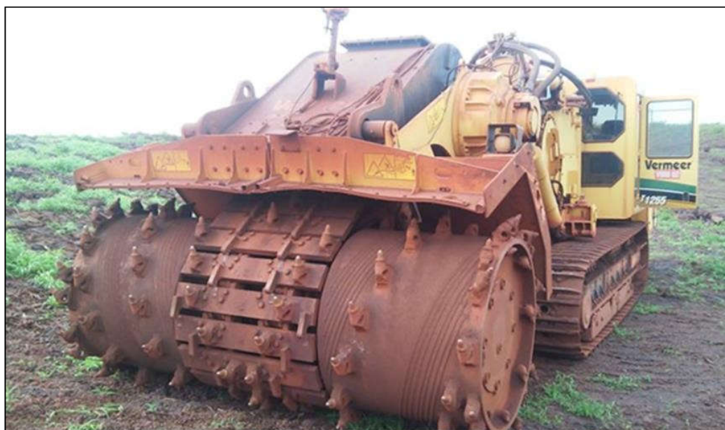
Figura 24. Minerador Contínuo de Superfície modelo Vermeer 1255D.
